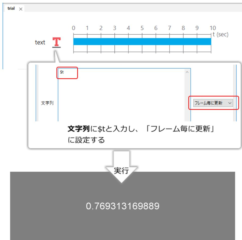
図 5.6 Builder の内部変数  $t$  のテスト。画面上にルーチン開始から経過した時間が表示されます。
