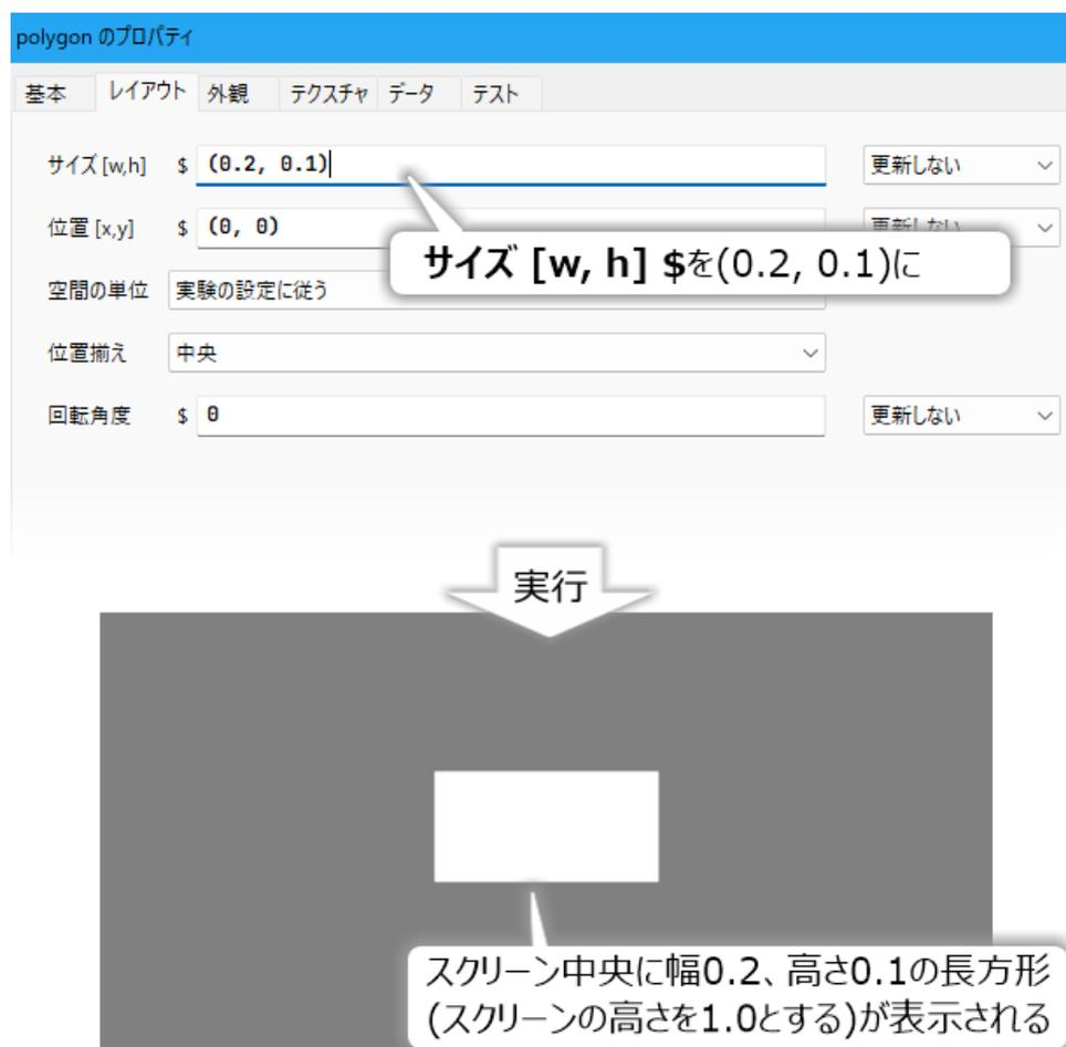
図 2.12 サイズの設定。Polygon コンポーネントの形状を長方形にして、横幅 0.2、高さ 0.1 に設定しています。
